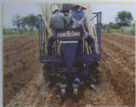
เครื่องปลูกอ้อยแถวคู่เหมาะสำหรับพื้นที่ที่มีการแตกกอแน่น ทรงกอแคบ
